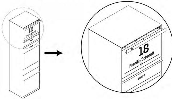
Dafür muss als erstes die oberste kleine Blende abgenommen werden. Die Blende ist magnetisch um die Verschraubungen der Schublade zu verdecken und somit zusätzlichen Schutz der Technik zu gewährleisten. Nehmen Sie die Blende mit Hilfe des mitgelieferten Hakenmagneten ab. Am besten funktioniert dies, wenn man den Magneten nicht mittig sondern am Rand der Blende platziert. Dabei darauf aufpassen, dass die Blende nicht herunterfällt!
