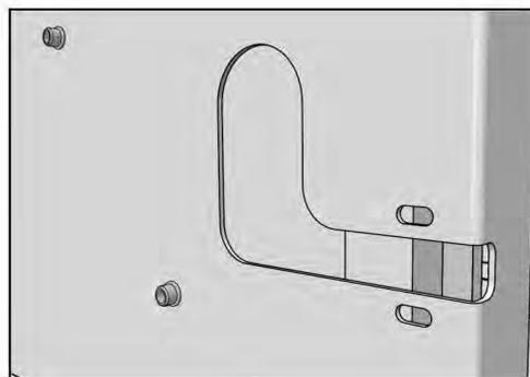
Nun muss das Anschlusskabel rückseitig in die Lampe geführt werden. Hierfür wurde in der Leuchtenhalterung rückseitig ein Auslass vorgesehen, so dass das Kabel einfacher eingeführt werden kann. (Schritt entfällt bei Variante ohne Leuchte)
