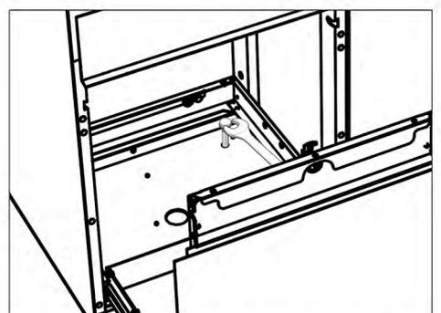
Mitgelieferte Schrauben mit Hilfe eines 13er Maulschlüssels in die Dübel schrauben.
