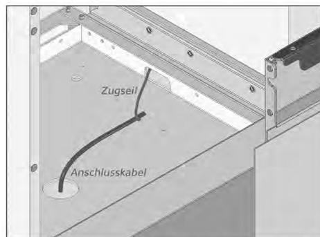
Paketbox platzieren und dabei das Anschlusskabel durch das mittige Loch im Boden der Box ziehen. Ein Zugseil ist für die Kabelführung bereits gelegt. Zugseil am Kabel befestigen.
