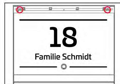
Nach Anschluss die Schublade wieder schließen und die Schrauben eindrehen.
