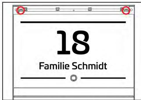
Die Verschraubungen sind nun zugänglich. Lösen Sie die beiden Sicherheitsschrauben links und rechts, mit einen Schraubendreher (Tx10).
