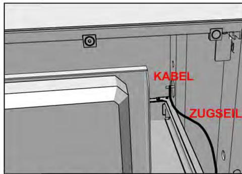
Die Schublade kann nun aufgezogen werden. Wir haben für Sie bereits ein Zugseil in das Rohr für die Kabelführung gelegt. So können Sie das Anschlusskabel leichter hoch in den Funktionskasten ziehen. Ziehen Sie das Anschlusskabel, dass Sie zuvor unten am Fuß an dem Zugseil befestigt haben nach oben in die Box.
