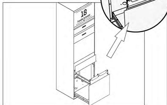
Einwurfklappe öffnen und Entnahmeschublade herausziehen. Anschließend die 4 Bohrlöcher anzeichnen.
