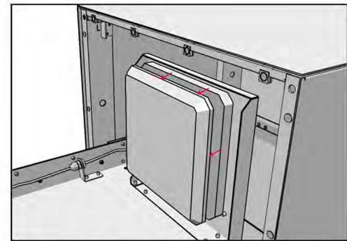
Zum Anschluss des Leuchtmittels, den Deckel entfernen. Hierfür eignet sich ein schmaler Gegenstand wie eine Münze oder ähnliches. Anschließend kommen Sie an die Anschlusskontakte der Leuchte. (Schritt entfällt bei Variante ohne Leuchte.)
